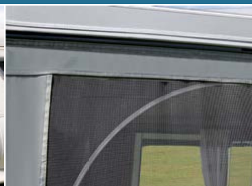
▲ Die Moskitowand wird mit Kunststoffprofilen am Regenrinnenkeder befestigt.
